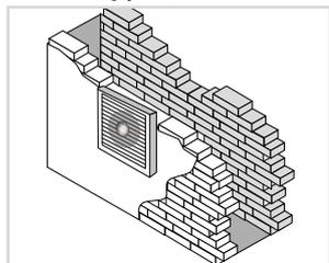
Для монтажа с воздуховодами Ø100, 120, 150 мм и квадратными отверстиями соответствующих размеров.
